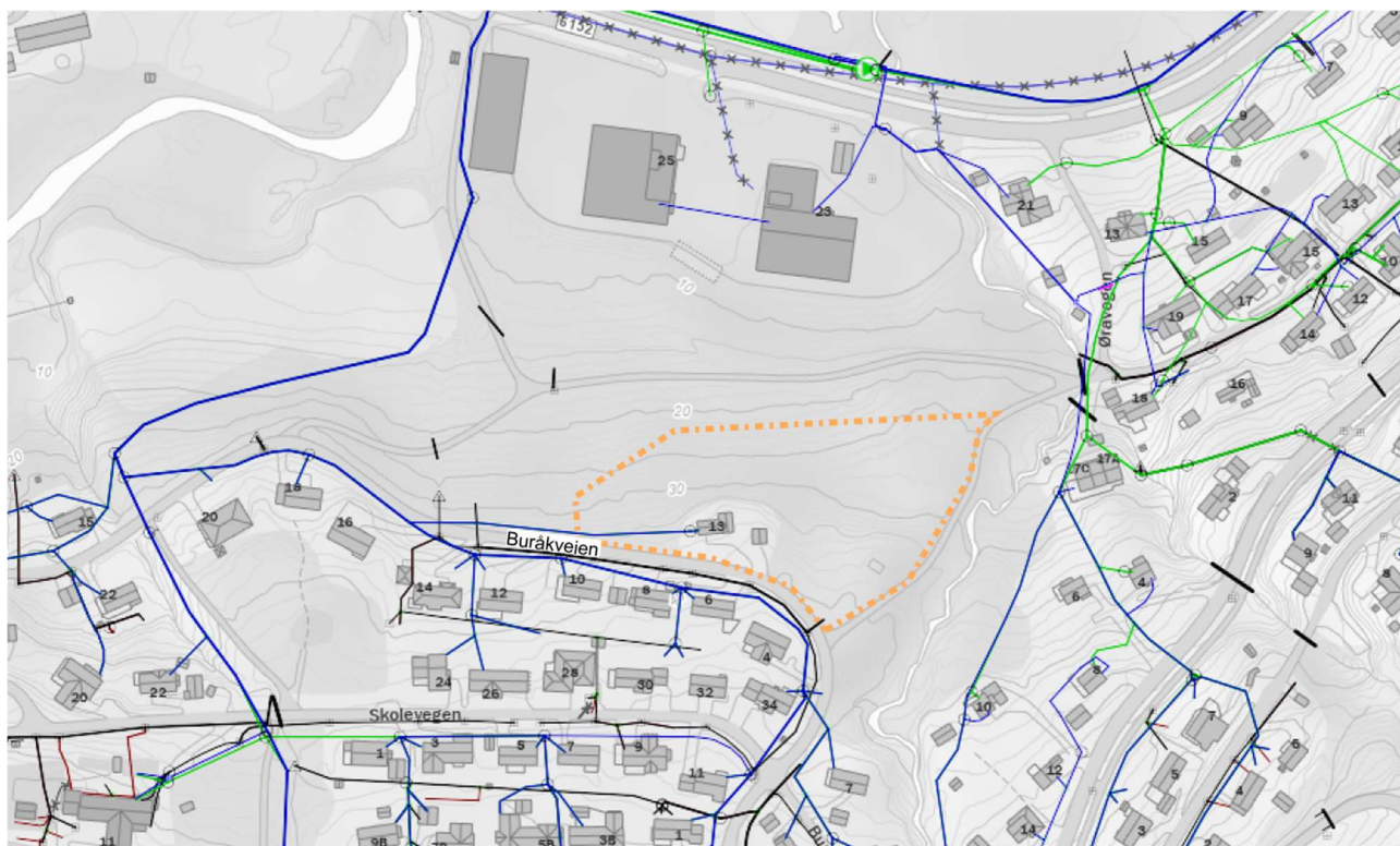
Figur 1 Kart over eksisterende ledningsnett. Utklippet er innhentet fra Surnadal kommune 12.08.24. Oransje stiplet linje markerer omtrentlig planavgrensning
